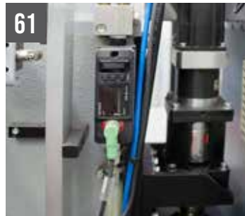
SHARK 460 KONNECT Führungsköpfe-kühlmittelflussvorrichtung
