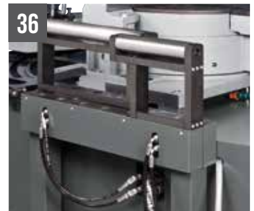
SHARK 652 SXI H 5.0 Hydraulisch angetriebene Heberolle (Zufuhr)
