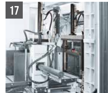
SHARK 350 NC HS 5.0 - Hydraulische Vertikalschraubstöcke für Bündelschnitte
