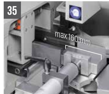
TIGER 402 CNC HR 4.0 Schraubstock zur Reststückeinschränkung
