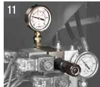
SHARK SXI evo Druckregler des hydraulischen Schraubstocks
