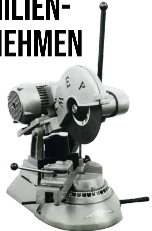
TV300 ist die erste serienmäßig hergestellte Trennschleif-Maschine
