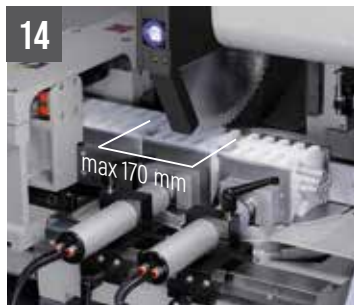
TIGER 402 CNC HR 4.0 - Serie an einrastenden Spannbacken f. Reststückeinschränkung
