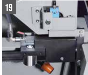
SHARK 350 CNC HS 4.0 - 350 CNC HS 5.0 Bandverlaufsüberwachung
