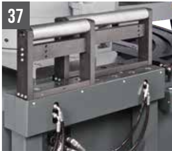
37 SHARK 652 SXI H 5.0 Hydraulisch angetriebene Heberolle (Abfuhr)
