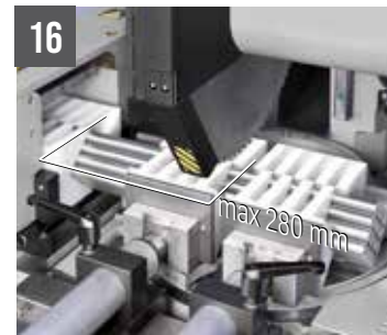
TIGER 402 CNC HR 4.0 - Serie an einrastenden Kunststoffspannbacken (max75x75mm)
