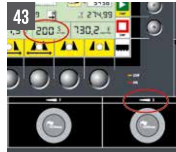
43 SHARK 350 CNC HS 4.0 / 350 NC HS 5.0 - Satz Sägebandgeschwindigkeit 15-200 m/min
